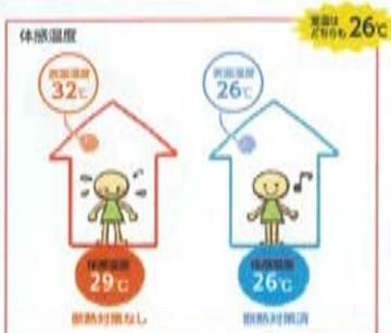
住宅の中で最も熱の出入りが大きい場所は、窓・ドアなどの開口部。全体の73%の熱が窓やドアから入ってきており、この熱が室内の温度を上昇させます。また、体が実際に感じる体感温度と室温は違うため、外からの熱の影響を少なくする断熱対策も重要です。
